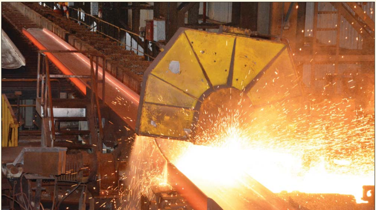
स्टील अथॉरिटी ऑफ़ इण्डिया लिमिटेड एनपीबी-750 (एनपीपी -750) नैरो पैरालेल प्लैट बीम्स सफलतापूर्वक रोल करने वाला पहला घरेलू स्टील निर्माता बन गया। बीम्स को सेल के इस्को इस्पात संयंत्र के नए और अत्याधुनिक यूनिवर्सल स्ट्रक्चरल मिल में लाया जा रहा है।
